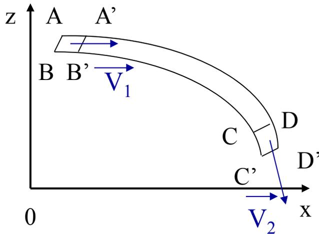
Considérons un tube de courant ABCD à l'instant  $t$  ; à l'instant  $t+dt$  il est en A'B'C'D'. On appelle  $q_m$  le débit massique constant.
