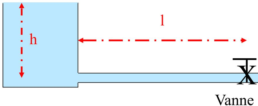
On cherche la relation entre le temps d'établissement de l'écoulement, la vitesse et la vitesse maximale du fluide
