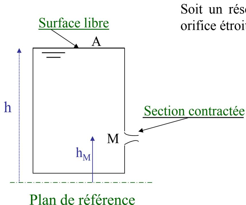
Soit un réservoir dont le fluide s'échappe par un orifice étroit
