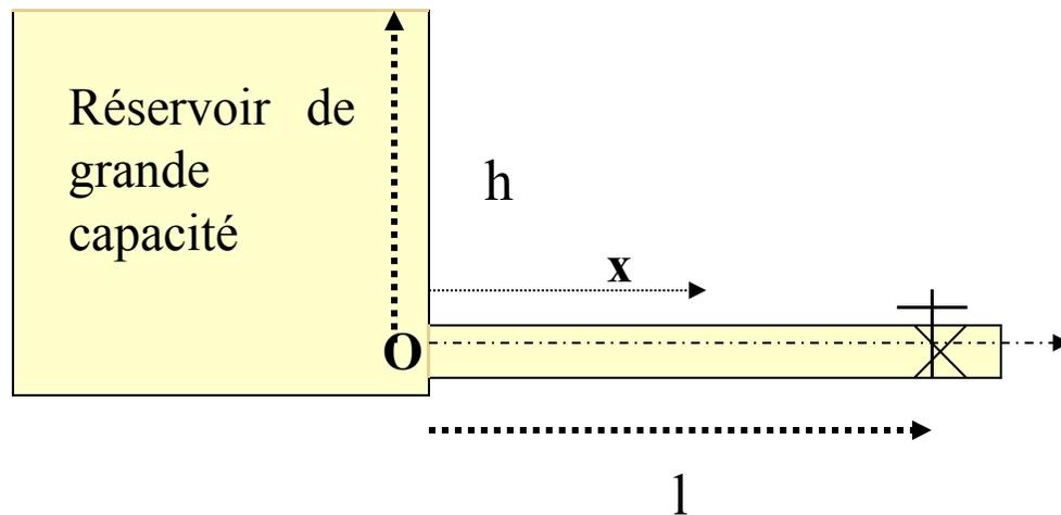
La vanne est ouverte, la conduite est le siège d'un écoulement permanent de vitesse  $V_m$ .
