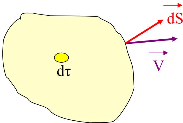
On considère l'écoulement d'un fluide **incompressible** en régime **non permanent** dans un volume  $\tau$ . On appelle  $F$  la force volumique exercée par les parois mobiles d'une machine sur le fluide.
