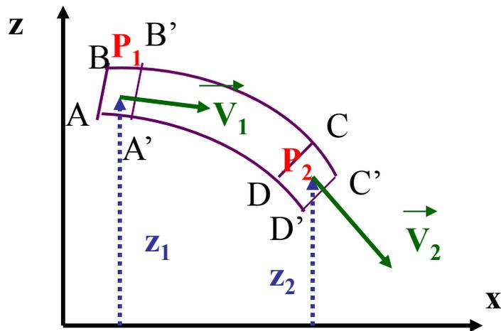
Les hypothèses concernant le fluide et l'écoulement sont les mêmes. On considère un filet de courant ABCD à l'instant  $t$ . A  $t + dt$ , le filet passe en A'B'C'D'.
