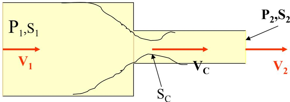
Dans le cas d'un rétrécissement brusque, l'expérience montre que la perte de charge ne se produit pas au niveau de la diminution de section du conduit mais lors de l'élargissement entre la section contractée du fluide et la section  $S_2$  en aval. Le calcul se fait comme précédemment, on obtient :
